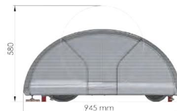
La altura de la cubierta una vez enrollada en su eje es de 580 mm
